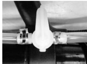
Рис. 8 Установка выпускного шланга на штуцер запорного крана
